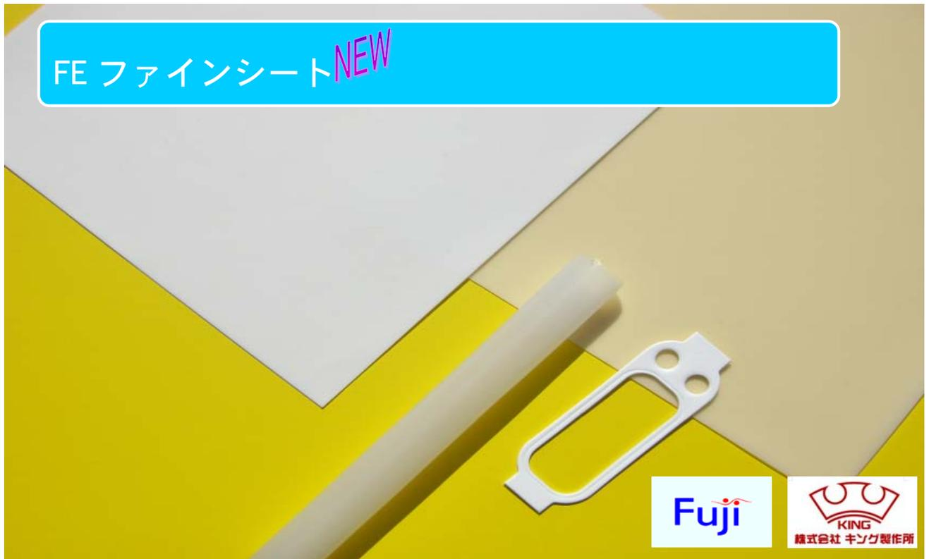
FE ファインシリーズ(シート・チューブ)は、PTFE多孔質にフッ素化ポリエーテルエラストマーを複合させることによりシリコンシートやシリコンチューブの様な柔軟性や復元力がありPTFEに比べて、柔軟でクッション性と復元力を持っており、又、耐引裂性に優れています。又、耐熱性も連続 200℃の高温から-50℃の低温までゴムとしての物性を保ち、耐薬品性はパーフロに相当し従来のフッ素ゴムよりエーテル類、アミン類、ケトン類、酸化剤、有機溶剤、酸、アルカリの薬品に対して安定性あり、繰り返し使用が出来る素材です。
